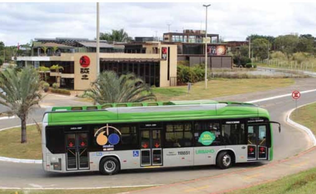
**Piracicabana DF conta com seis ônibus totalmente elétricos fabricados pela BYD (modelo D9W), com carrocerias Marcopolo Torino Low-entry**
