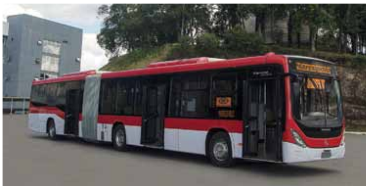
Os ônibus Torino são articulados, com chassi Mercedes 0500 UA Euro 6
