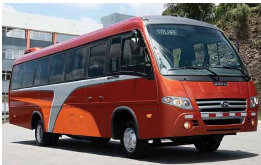
Os miniônibus Attack 9 têm 8.900 mm de comprimento e 2.320 mm de largura
