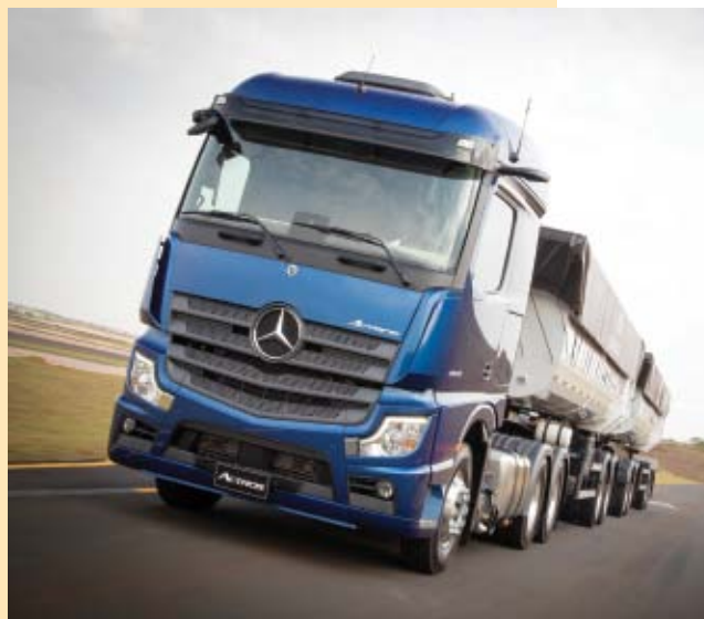
Os retrovisores externos do Actros foram substituídos por um sistema digital com câmeras
