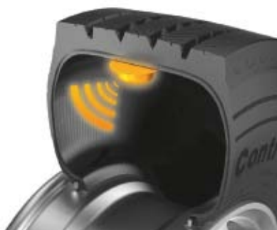
Sensor TPMS instalado na parte interna
