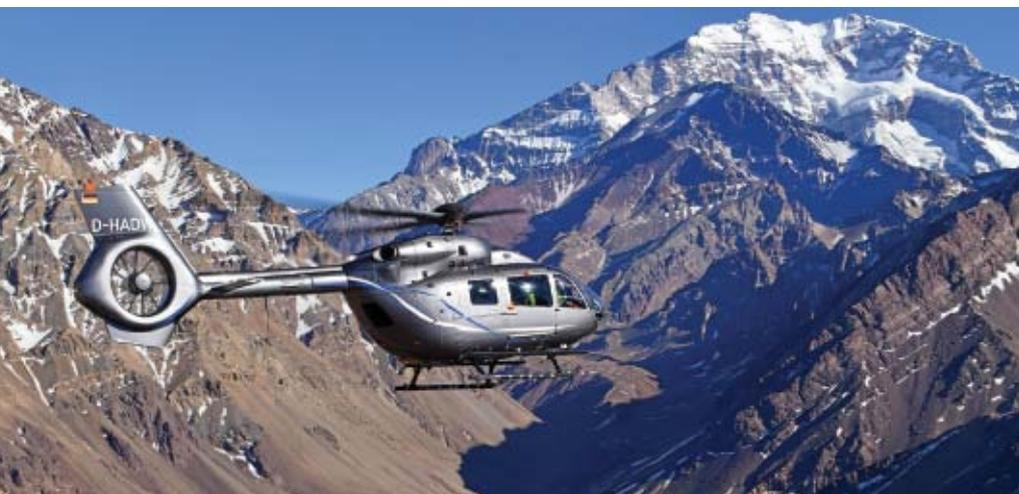
**O helicóptero H145 possui rotor de cinco pás, aumentando em 150 quilos sua carga útil**
