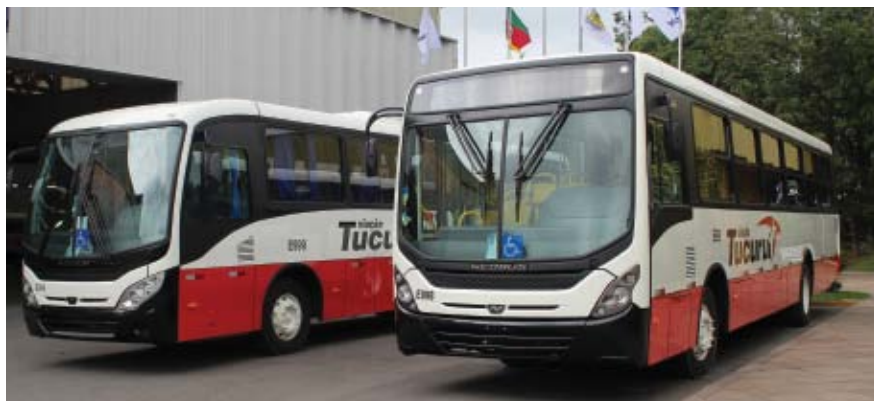
Os ônibus da Viação Tucuruí foram encarroçados sobre chassis Mercedes-Benz OF-1721
