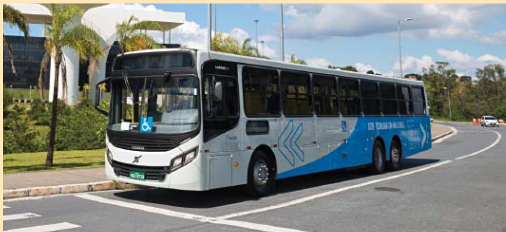
A Volvo destaca o modelo B270F 6x2 com carroceria da Caio de 15 metros
