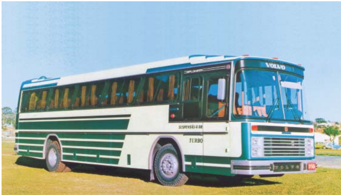
B12R (à dir.), chassi rodoviário com motor traseiro foi a novidade em 2003 e B58 rodoviário (à dir.), com motor turbo e suspensão traseira, foi outro destaque da marca
