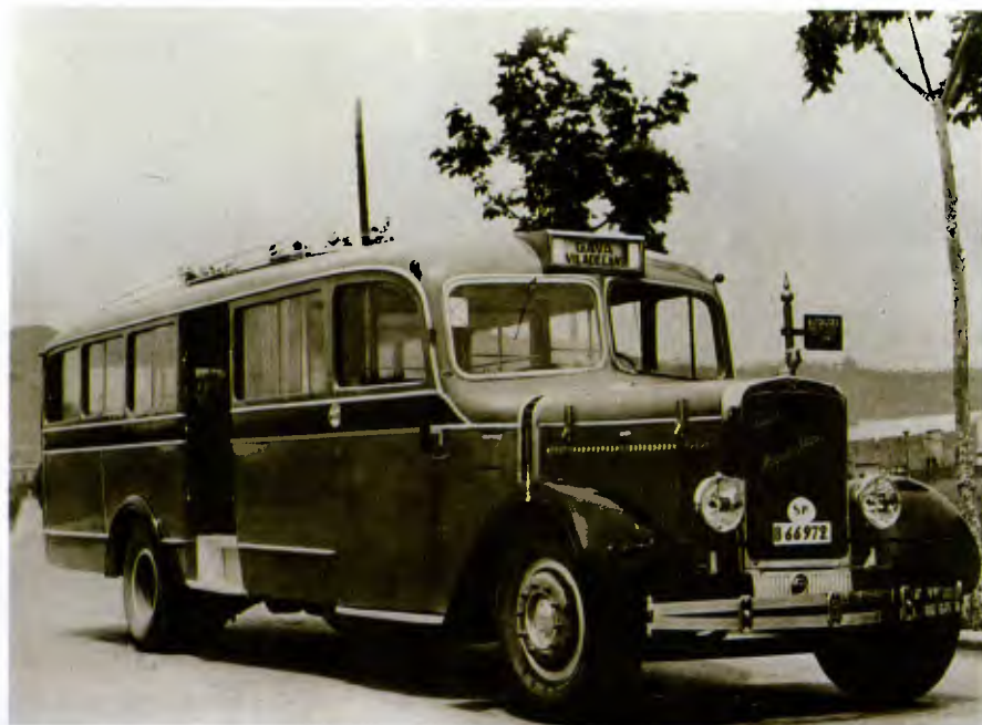
Outro chassi T69, com motor de 107 cv, com 6 cilindros
