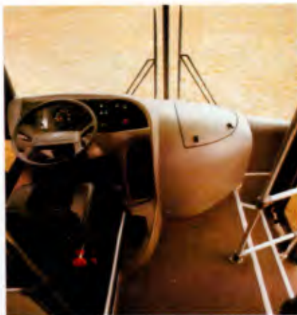
Painel: moldado em fibra de vidro na cor cinza; o teto é em fibra e as luminárias foram reestilizadas e reposicionadas em relação ao Mega convencional
