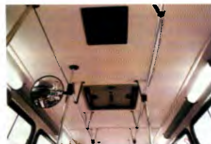
Painel: moldado em fibra de vidro na cor cinza; o teto é em fibra e as luminárias foram reestilizadas e reposicionadas em relação ao Mega convencional
