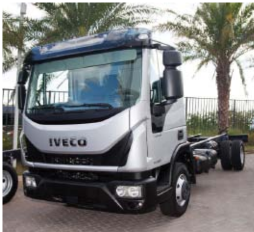
Os novos modelos Tector estão equipados com motor NEF45 de 190 cv de potência
