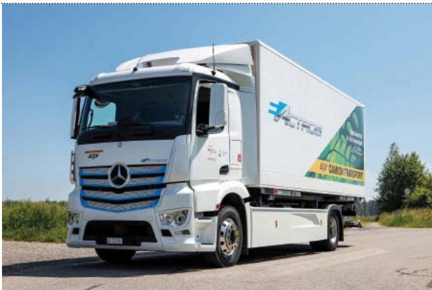
O eActros de 2 eixos e 18 t de PBT transporta carga em uma carroceria intercambiável
