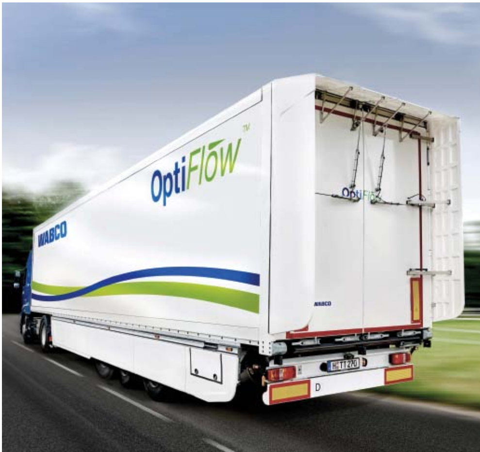
O OptiFlow Tail é uma solução aerodinâmica que direciona o fluxo de ar para reduzir a resistência
