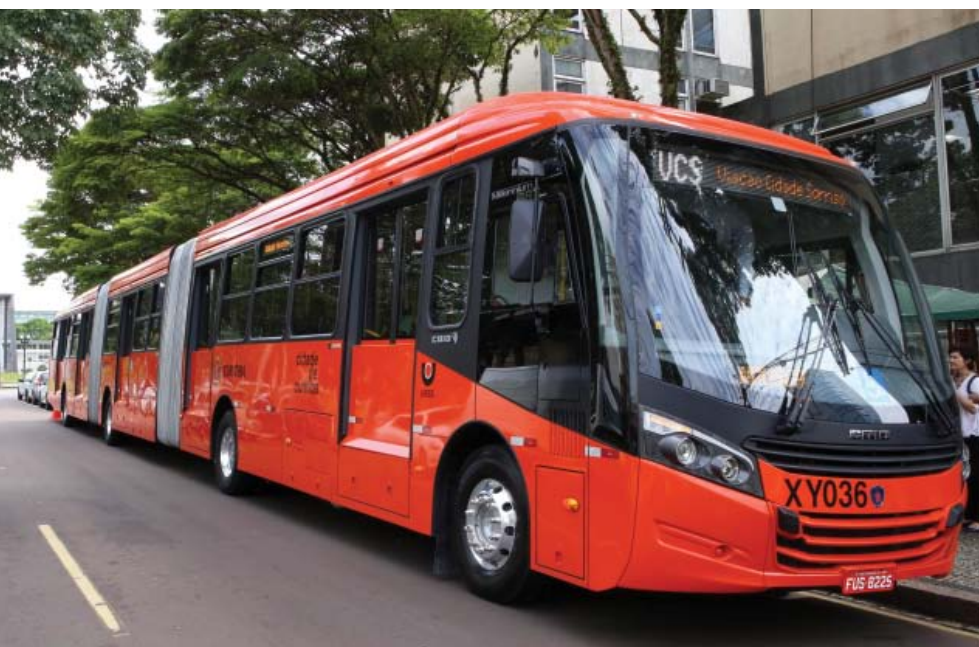
O biarticulado Scania F 360 HA 8x2 tem carroceria Caio Millennium BRT
