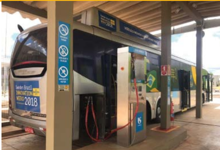
O motor a gás do veículo pode ser abastecido com biometano ou GNV
