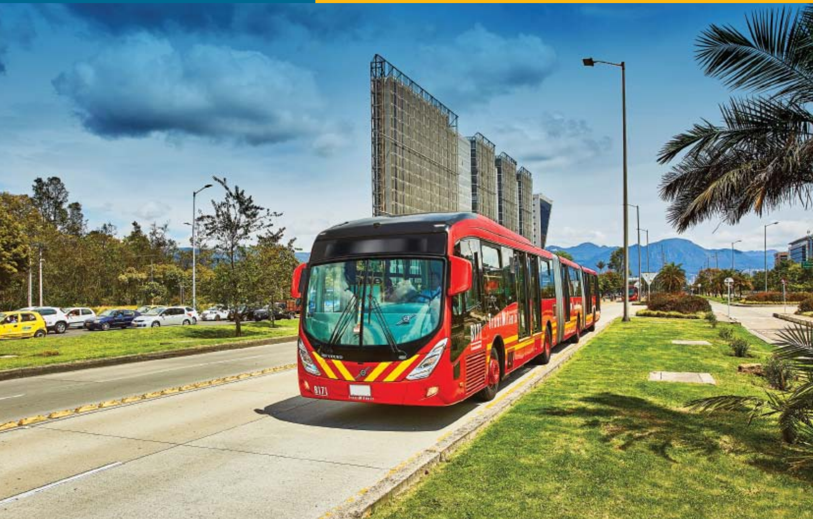
Os ônibus articulados e biarticulados Volvo B340M têm motor de 340 cv de potência e carroceria da Marcopolo
