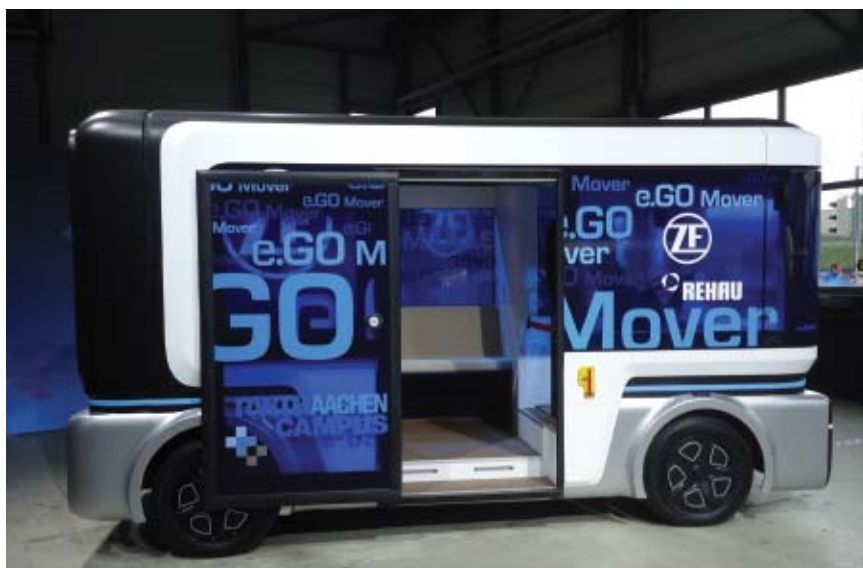
O e.Go Mover autônomo possui sistemas de acionamento elétrico, direção e freios da ZF
