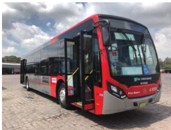
Apache Vip tem três portas tipo fole, com embarque dianteiro
