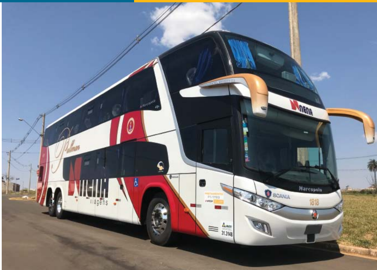
O modelo rodoviário Scania K 400 6x2 é equipado com o sistema de segurança ADAS, que ajuda o motorista na condução
