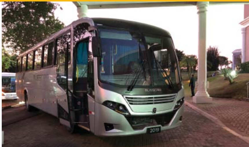
Elbuss 320 é configurado para chassis com motor dianteiro de 15 e 17 toneladas
