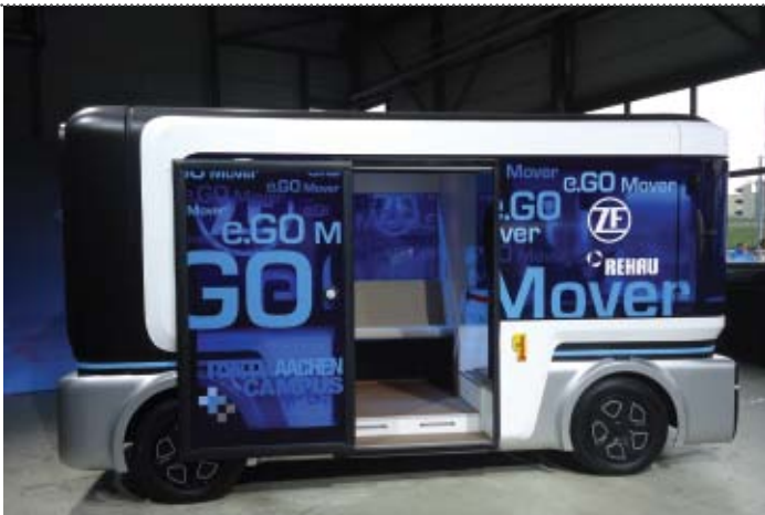
O miniônibus e.GO Mover pode transportar até dez pessoas sentadas... ...e seu módulo superior tem suportes para ser posicionado no chão
