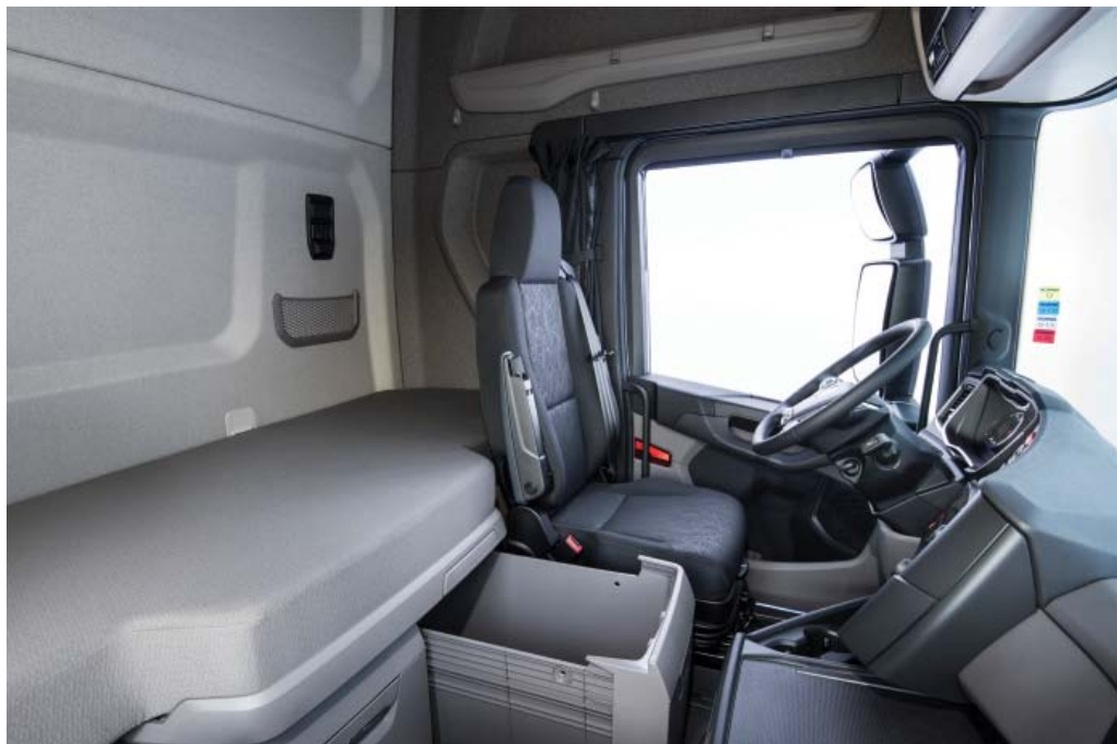
A novidade na cabine S está no piso plano para facilitar o deslocamento interno do motorista
