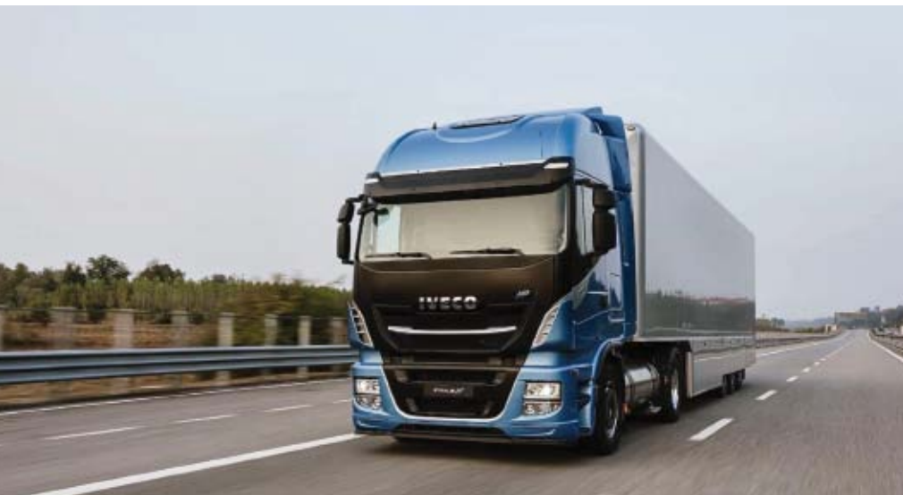
A Iveco mostrará um Stralis NP 400 de 26 t carroceria refrigerada, movido a gás natural
