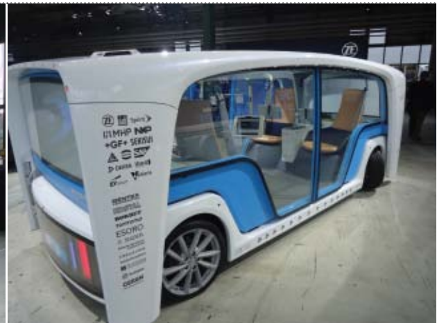
O miniônibus e.GO Mover pode transportar até dez pessoas sentadas... ...e seu módulo superior tem suportes para ser posicionado no chão
