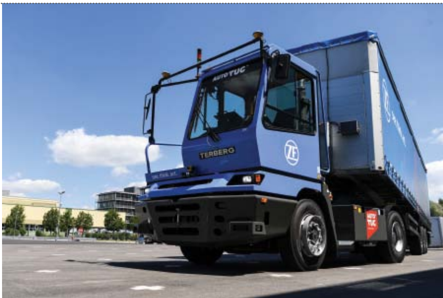
Terminal Yard Tractor manobra sozinho o semirreboque até a doca para carregar e descarregar
