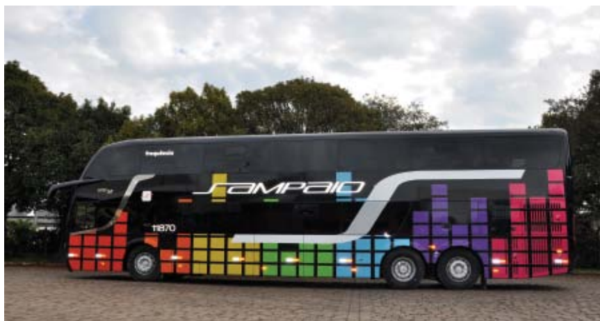
O Campione Invictus DD de 14 metros possui 48 poltronas semileito no salão superior
