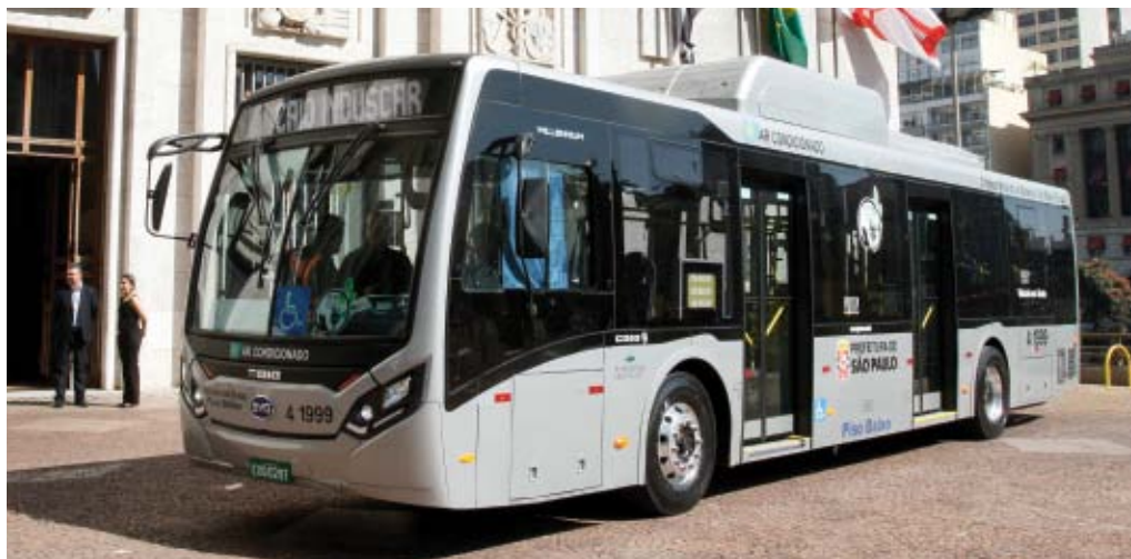
O Millennium na versão elétrica BYD tem baterias com autonomia de 250 quilômetros
