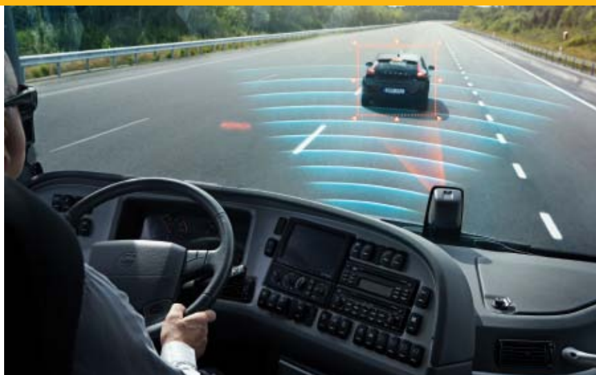
O Heads Up Display, faixa vermelha que aparece no para-brisas para evitar risco de impacto
