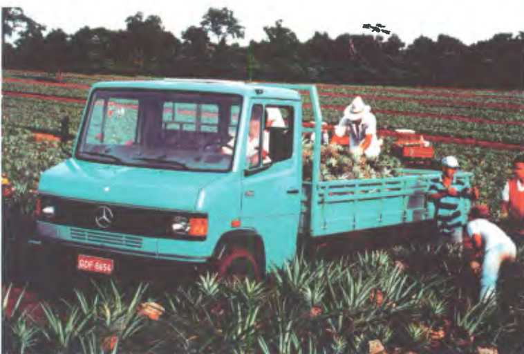
O caminhão leve 710, entre os mais vendidos da marca, tem entre-eixos de 3.700 mm e motor OM-364 A de 109 cv
