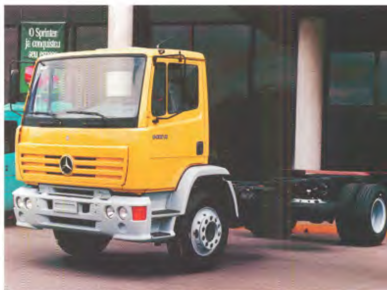
1418R, com entre-eixos de 5.170 mm, motor turbo OM366A de 170 cv para aplicação urbana, rural e rodoviária
