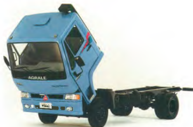
O 7.500 Turbo, com motor MWM 4.10 T de 122 cv, tem capacidade de carga de 4.380 kg
