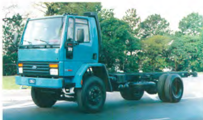
Semi-pesado Cargo C-1622, de 16 t, com duas opções de entre-eixos, para transporte de cargas diversas
