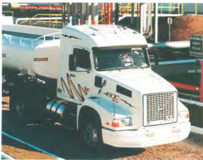
O modelo NL 10 EDC Gold, com opções de entre-eixos de 3.800 mm a 5.400 mm, motor D10A de 320 cv que atende ao Euro II, dá destaque à segurança e ao conforto
