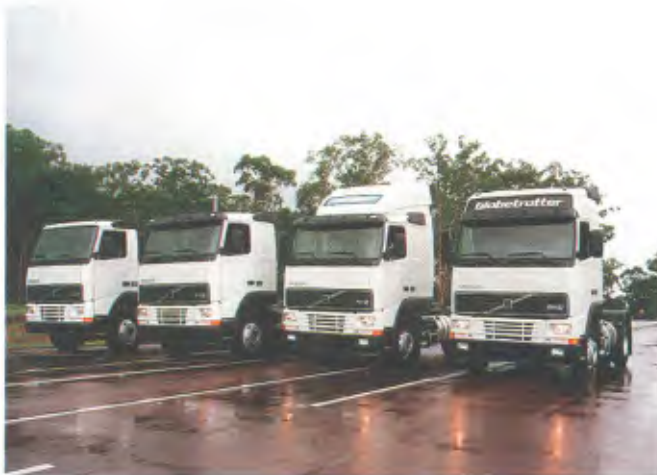
A linha de caminhões FH12 380 tem quatro modelos, incluindo três com cabine-leito, e é equipada com motor D12A que desenvolve 380 cv
