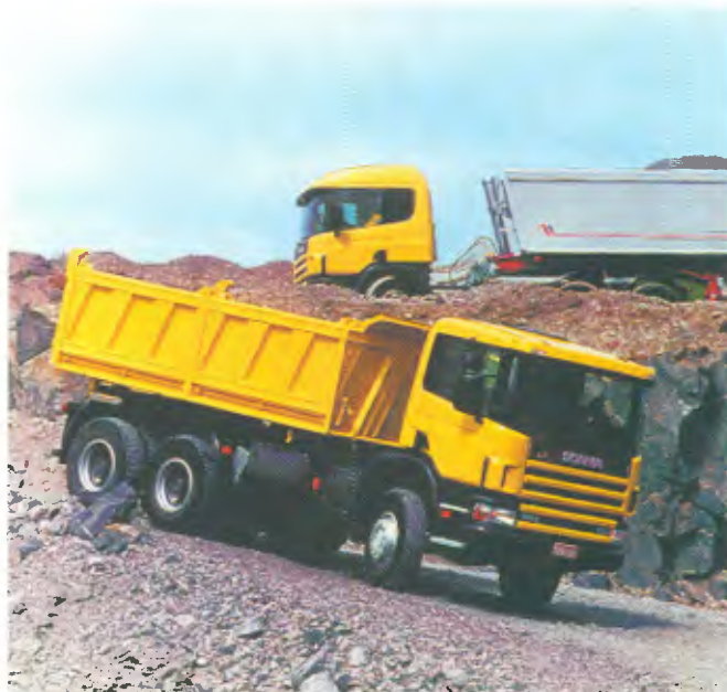
O caminhão P94CB, 6x4, também da Classe 4, com cabine avançada baixa, destinado a operações severas, com capacidade de tração de até 150 t
