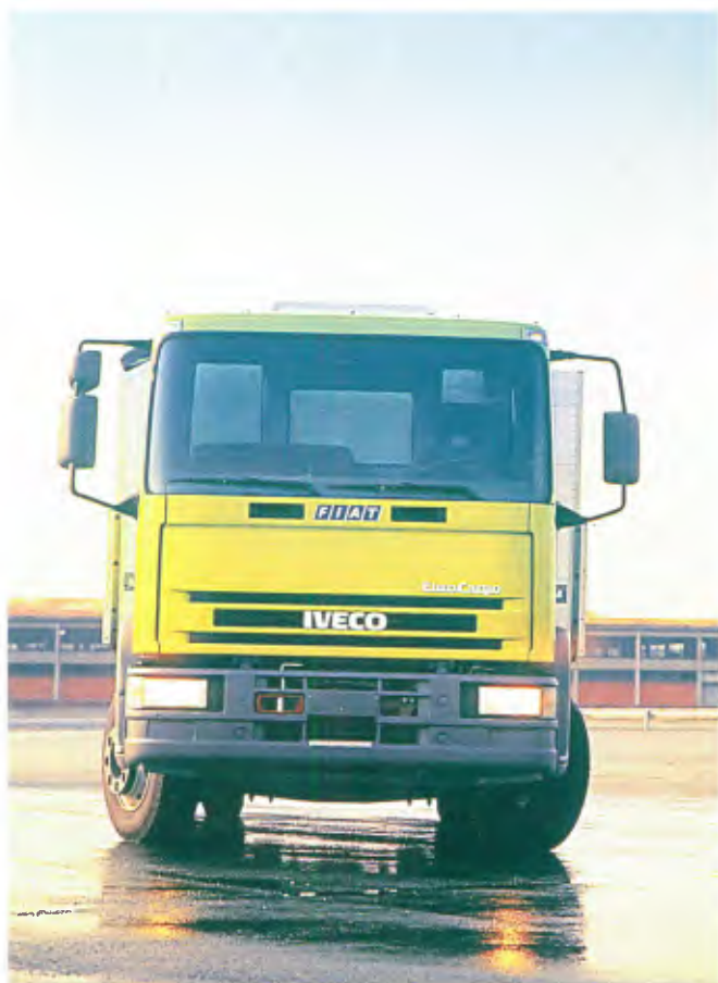
O EuroCargo, 4x2, de 15 a 16 t, com opções de entre-eixos 3.690 mm e 3.465 mm, é adequado para curta e média distâncias
