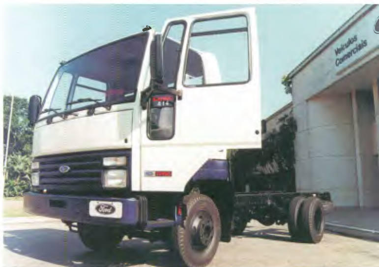
Cargo 814, de 7,7 t, equipado com motor Cummins B Turbo de 140 cv, um dos líderes do segmento
