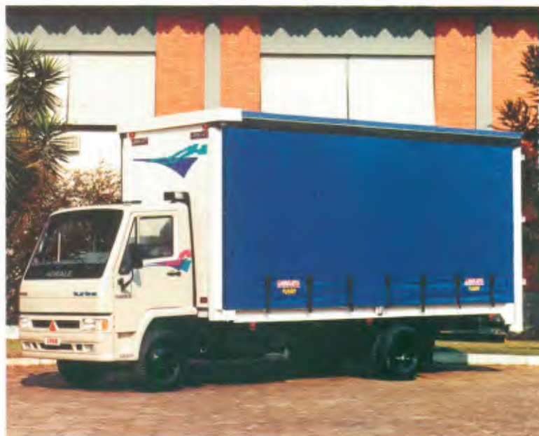
Caminhão 8.500 Turbo, 4x2, o mais pesado da linha Agrale, é disponível com entre-eixos 3.500 mm e 4.200 mm
