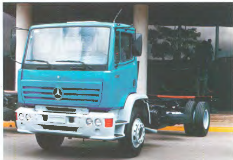
O novo 1723 para aplicações urbanas ou rodoviárias é equipado com motor turboalimentado OM 366A, de 170 cv
