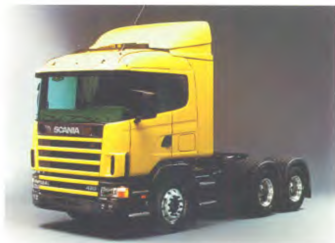
O novo R124LA, 6x2, da Classe 4, com cabine avançada alta, motorização de 360 cv ou 420 cv, e capacidade para tracionar até 60 t, para transporte interestadual e internacional
