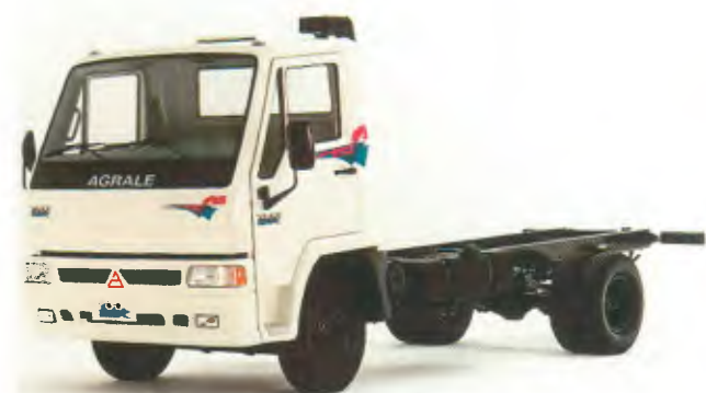
O modelo 7000, possui motor MWM 4.10 de 95 cv, para cargas secas e refrigeradas
