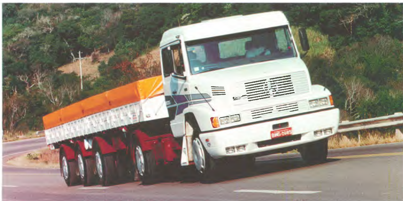
O extrapesado LS-1935, com motor OM-447 que desenvolve 360 cv, para semi-reboque de três eixos
