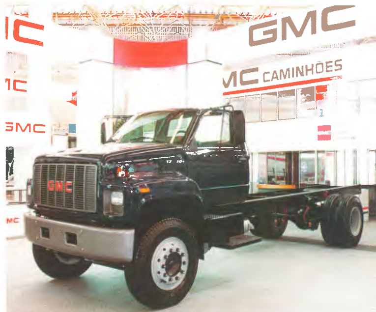
O caminhão 12-170, equipado com motor Caterpillar 3116 de 172 cv, destina-se a entregas urbanas de grande volume e outras aplicações.
