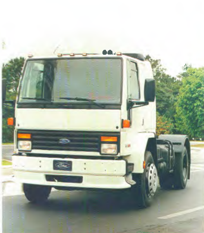
C-4030, 4 x 2, destinado a semi-reboque de três eixos com baú para carga seca ou isotérmica
