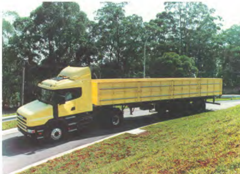
O modelo T114G, 4x2, de 18 t, com motores de 320 cv ou 360 cv, para transporte geral em estradas em condições variadas
