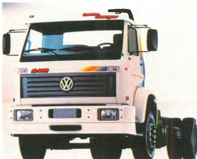
O caminhão 16.300, para cargas em médias e longas distâncias, tem motor Cummins 6CTAA de 291 cv
