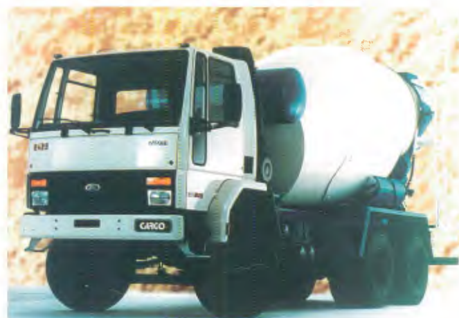
O recém-lançado Cargo Mixer, 6 x 4, com motor Cummins Turbo de 250 cv, com capacidade de 24 t
