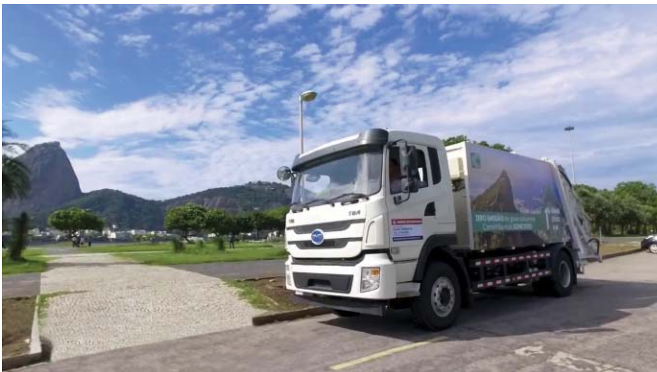
Com PBT de 21 toneladas na versão 4x2, o caminhão elétrico tem autonomia estimada de oito horas de operação por recarga
