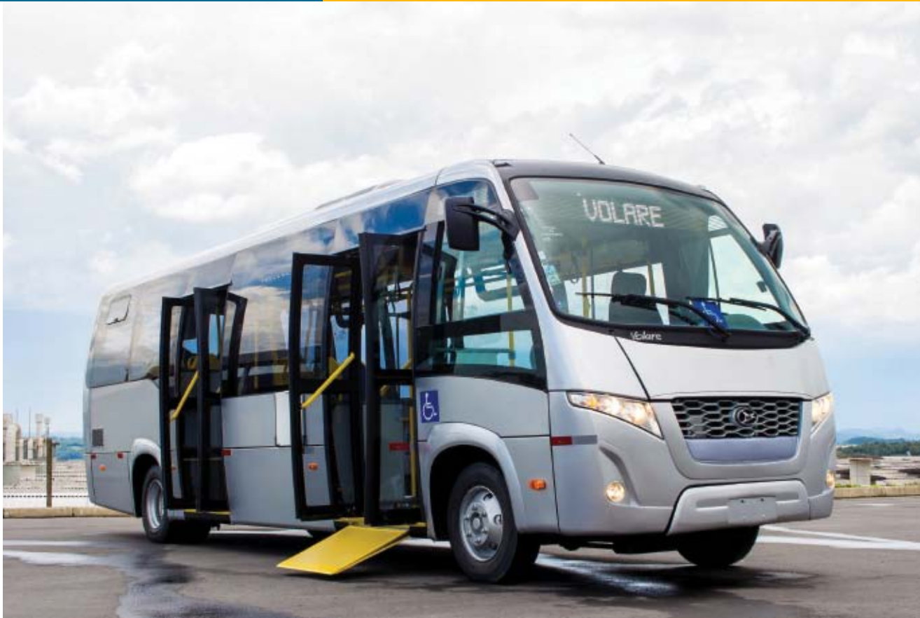
Com 8,9 m de comprimento, o Volare Access possui piso baixo, motor Cummins de 162 cv e transmissão Eaton de 5 marchas
