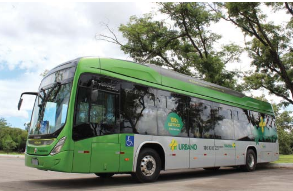
O ônibus elétrico BYD D9W piso baixo, com carroceria Marcopolo, tem autonomia de 300 km
