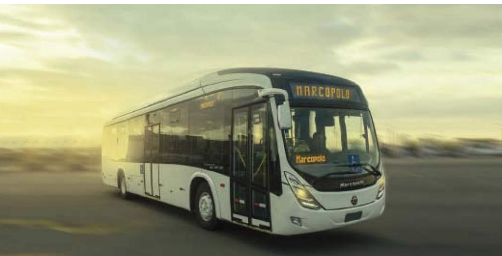
Marcopolo Viale destinado à Nigéria tem chassi Scania K250 UB 4x2 e 13 m de comprimento
