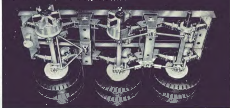
Eixos retificados com assentamento micrométrico dos rolamentos e ponteiros com roscas laminadas a frio.
