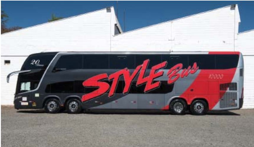
O K 440 8x2 é equipado com câmbio Opticruise de quarta geração e sistema antitombamento
