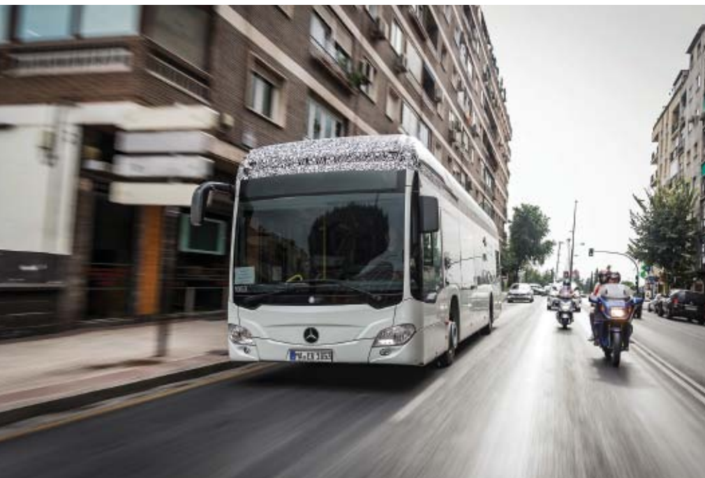
O Citaro totalmente elétrico recebe sua energia de acionamento de baterias de lítio-íon
