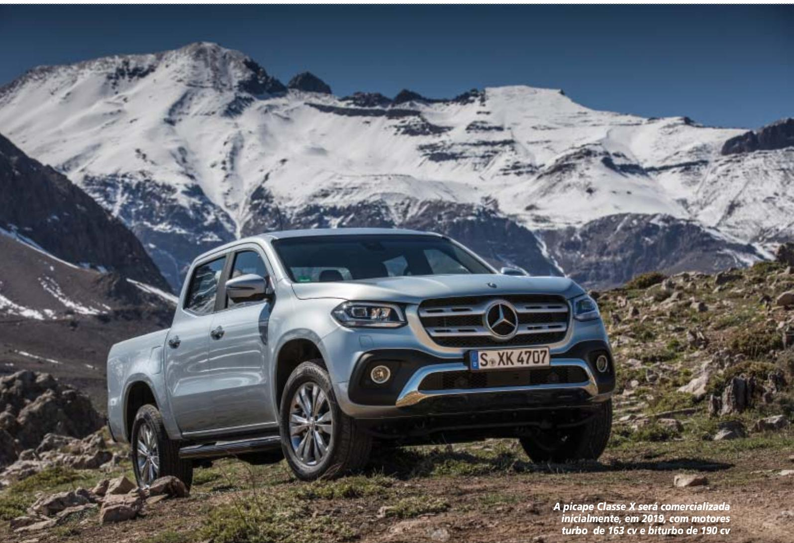
*A picape Classe X será comercializada inicialmente, em 2019, com motores turbo de 163 cv e biturbo de 190 cv*
