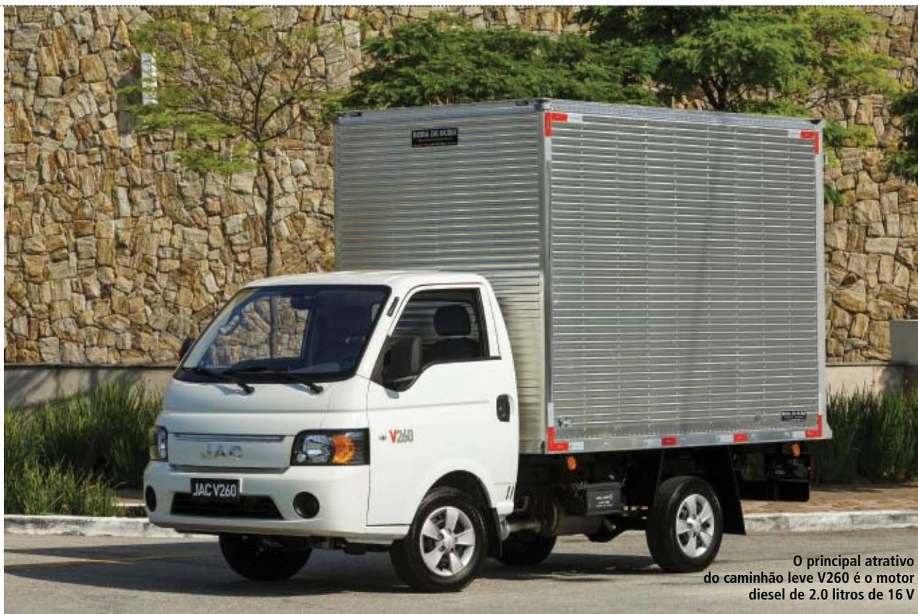
O principal atrativo do caminhão leve V260 é o motor diesel de 2.0 litros de 16 V
