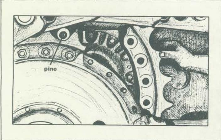
No sistema de segmentos, a substituição é feita sem necessidade de desmontar a esteira. Movimenta-se a máquina de forma a deixar um segmento entre o vão da esteira, retiram-se os parafusos e faz-se a troca.
