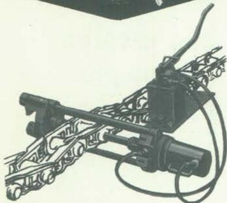
Prensas Hidráulicas Portáteis "Saca-Pinos" (PM 70 e PM 110) para tratores CATERPILLAR, ALLIS-CHALMERS, FIAT ou similares, servem também para sacar e colocar rodas motrizes de tratores D-2/D-9 Cat. e cubos de rodas de motoniveladoras Cat. 12 E em diante.
