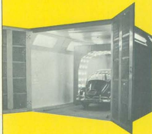
**Utilizando a cabine de pintura automotiva com módulo de secagem DeVilbiss.**
