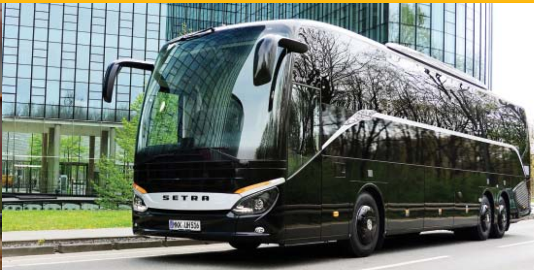
Setra ComfortClass S 516 Hd/2: rodoviário de 13 metros e dois eixos tem motor OM 470 Euro 6c e transmissão Mercedes-Benz de 6 ou 8 marchas
