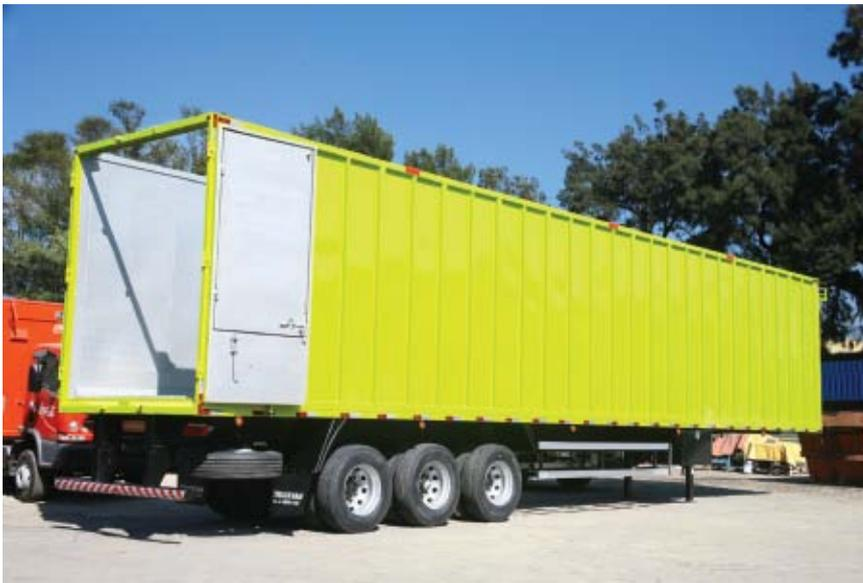
**Semirreboque com piso móvel para transporte de biomassa que facilita as entregas**
