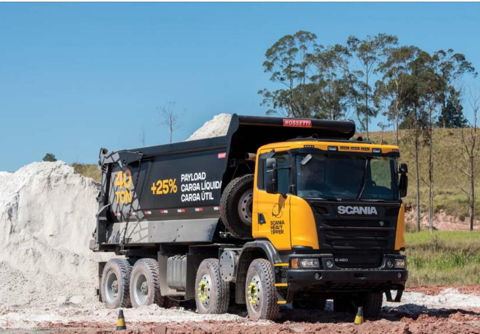
O Scania Heavy Tipper 8x4 P 440 tem 58 toneladas de PBT e capacidade para levar 40 toneladas de carga líquida
