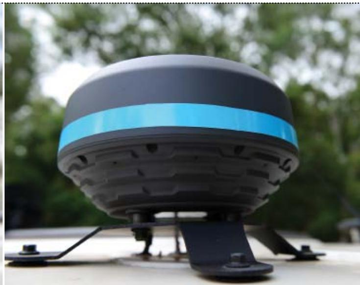
**A tecnologia de automação no veículo é composta por duas antenas GPS de elevada precisão e dois giroscópios de alta sensibilidade**
