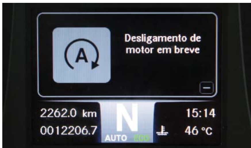
Tela no painel previne o motorista sobre o desligamento automático dentro de pouco tempo
