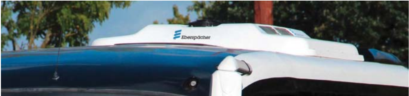
AC 188 sistema split pode equipar ônibus rodoviários normais e double deckers
