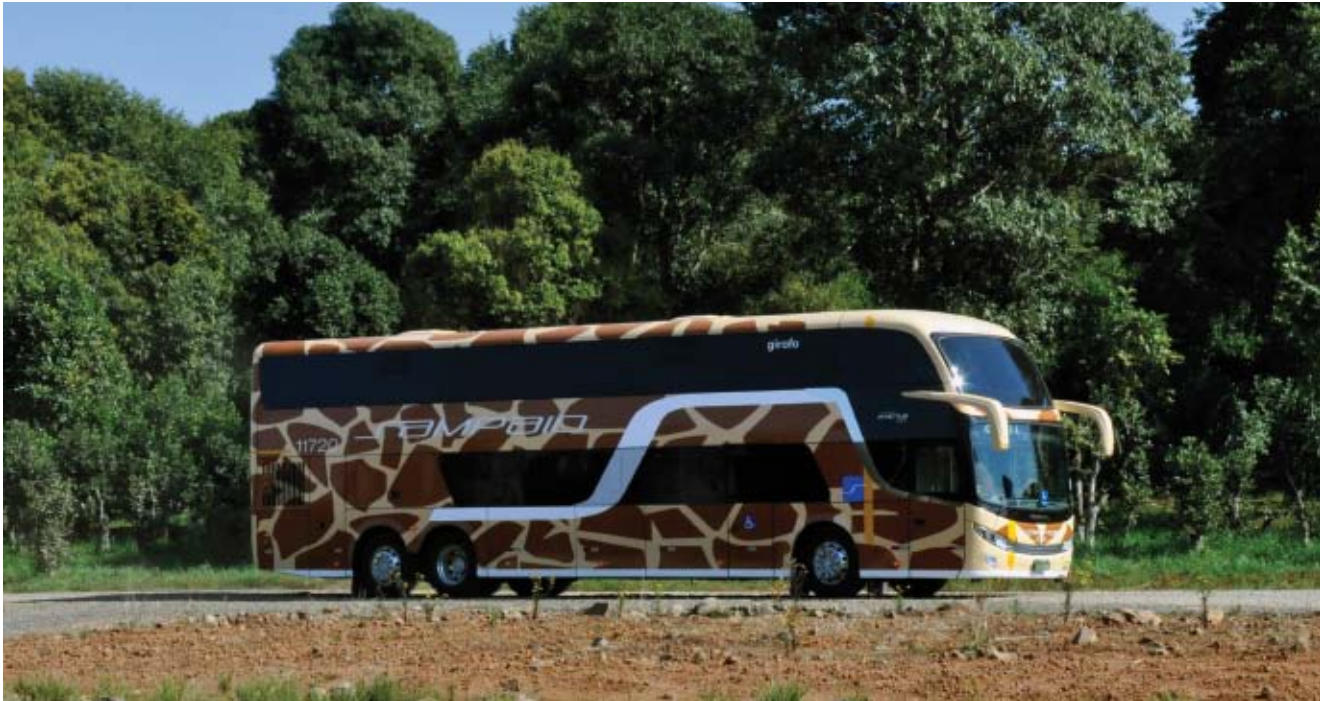
Campione Invictus DD de 14 m com chassi Mercedes-Benz O 500 RSD dá grande destaque ao entretenimento
