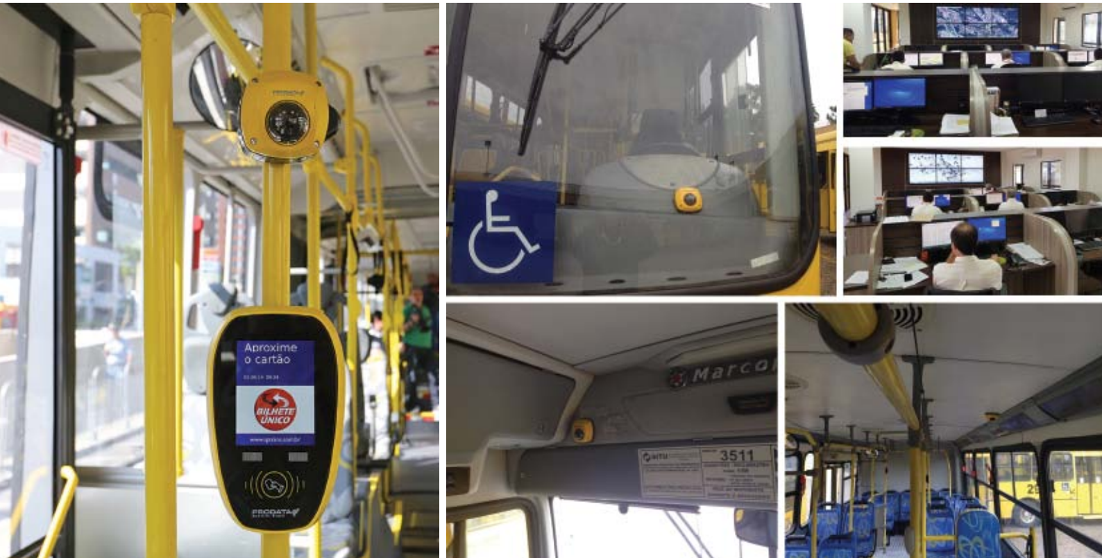
O validador V3680 coleta as informações de bilhetagem, posições de GPS e gerencia as comunicações com o centro de controle operacional
