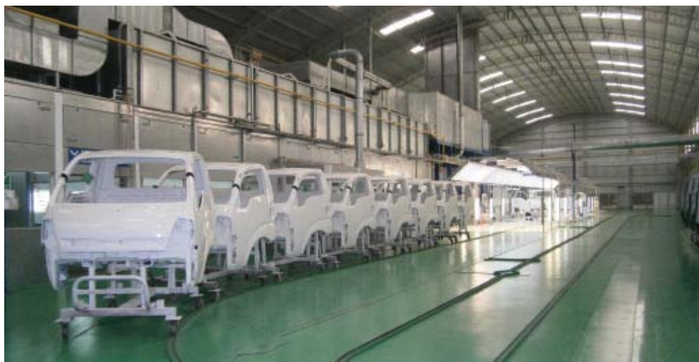
Com a retomada da produção, a Nordex investiu em novo sistema de pintura de cabine
