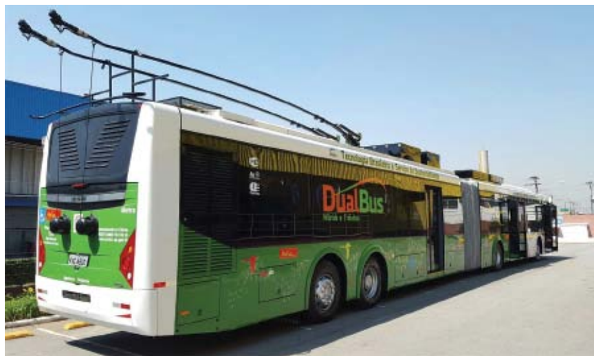
Dual Bus da Eletra pode ser alimentado por várias fontes de energia
