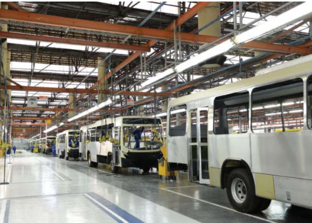
Fábrica de Xerém pode produzir até dez carrocerias por turno em única linha de montagem
