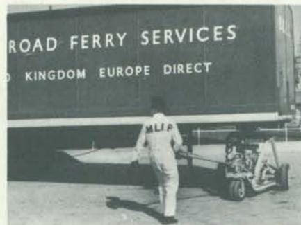
**Mini-trator** — De três rodas, controlado por operador a pé, para manobrar semitrailers de até 10 t. Acionado por motor diesel de 8 HP. Dimensões: 1,46 m de largura e 1,43 m de comprimento. A quinta roda engata automaticamente no semitrailer. Os controles estão montados no braço manejado pelo operador. **M. L. Aviation Co. Ltd. — White Waltham Aerodrome — Maidenhead, Berkshire, England. /SC-52.**
