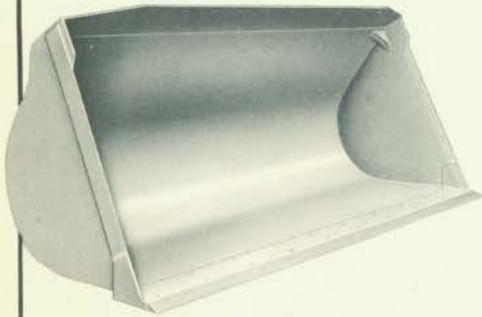
**Caçamba de aplicação geral.** É construída de chapa de aço reforçada, altamente resistente ao desgaste. As bordas cortantes são endurecidas pelo sistema "Hi-Electro". Dentes para penetração em material duro são também oferecidos, opcionalmente.
