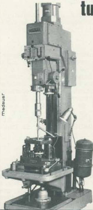
Chama-se **Mandrilhadora Vertical**, de grande curso. Responsável pelo acabamento da superfície da sede dos mancais (6 a 8 micropolegadas e em perpendicularidade de "furo com face" de 001 milésimo de polegada). Como a Mandrilhadora, outras máquinas garantem a precisão Lacom, para que seu Turbocompressor assegure mais potência e maior duração aos motores diesel.
