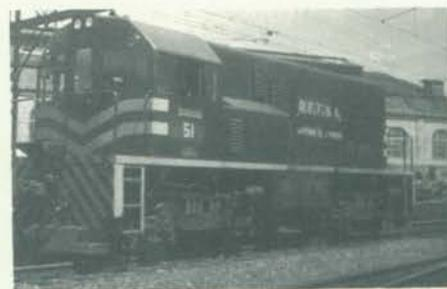
A locomotiva diesel-elétrica que será fabricada no Brasil terá potência de 1050/950 cv, equipada com motor diesel Caterpillar, com tração através de quatro motores tipo GE 761. A velocidade máxima gira em torno de 103 km/h, sendo seu peso em ordem de marcha de 60 t e seu esforço de tração a 30% de aderência, de 18 t. Será equipada para controle múltiplo, que permitirá o acoplamento de várias unidades para tracionar grandes cargas com perfeita
