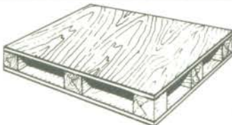
C24 Painel cheio com quatro entradas e duas faces para empilhadeiras.
