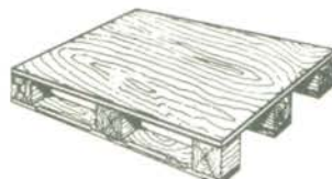
C14 Painel cheio c/ quatro entradas e uma face para empilhadeiras e carrinhos.
