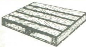
R22 Normal com duas entradas e duas faces para empilhadeiras.
