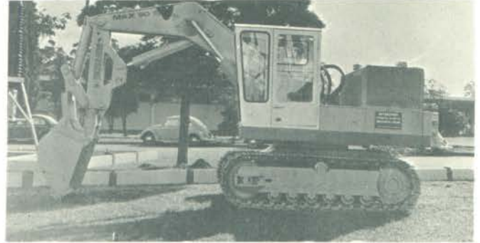
Escavadeira Max 90, totalmente hidráulica.
