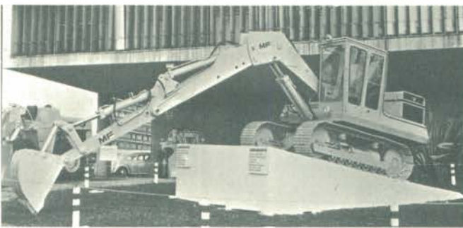
Escavadeira MF-350, com motor de 73 HP.
