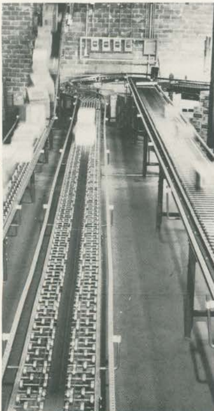
As caixas se apóiam em rodízios e são tracionadas por uma correia central.
