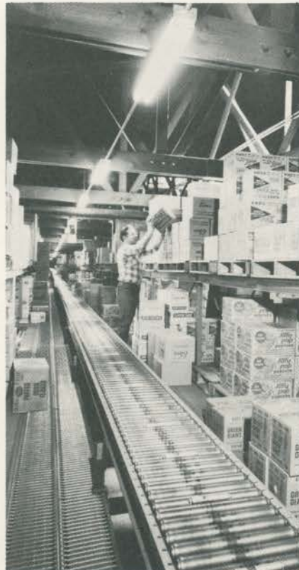
A apanha das caixas é feita por computador, na seqüência da estocagem.
