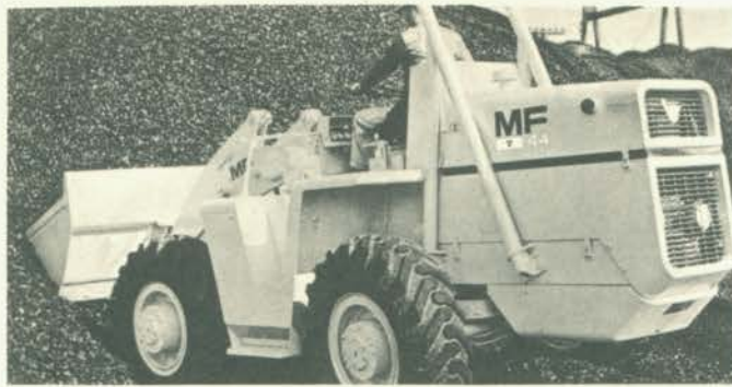
Pá-carregadeira MF 44, dotada de tração nas quatro rodas.
