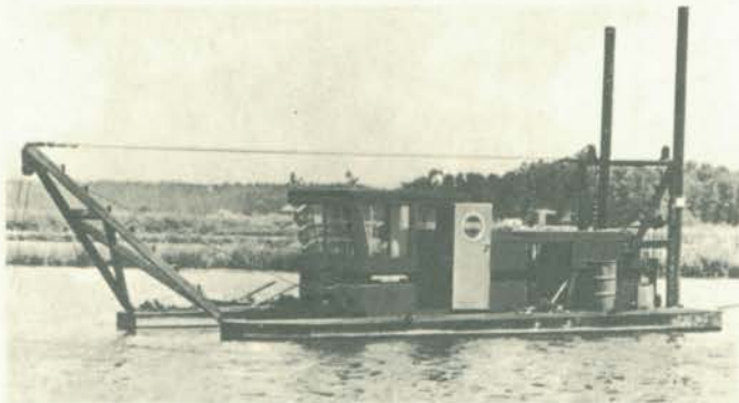
Draga PD-65, de 28,8 t, pode ser transportada por caminhão.
