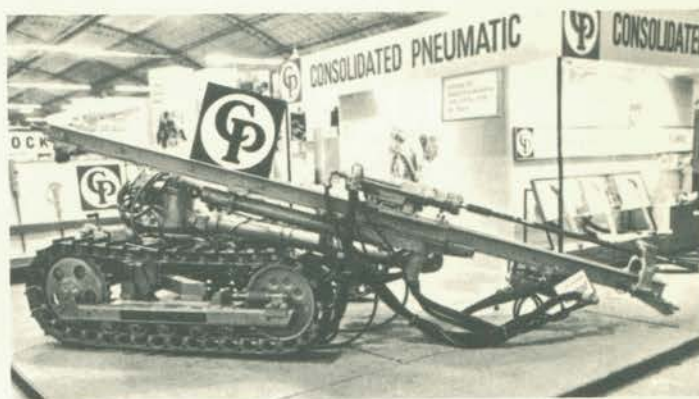
Perfuratriz pneumática de rocha, acionada por um compressor.
