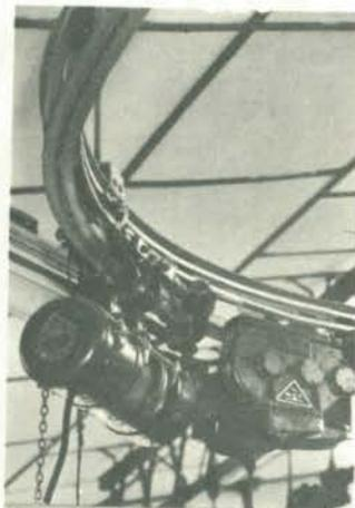
**MONOTRILHO** — Para indústrias, armazéns e plataformas de embarque onde não exista um fluxo contínuo de material. Consiste numa talha, montada sobre roletes de aço, que se desloca ao longo de um perfil em "I". Permite a movimentação vertical da carga e seu deslocamento ao longo da linha de caminhamento, de comprimento variável. A talha é elétrica e pode ser dotada de implementos para manuseio de cargas irregulares. /SC-18.
