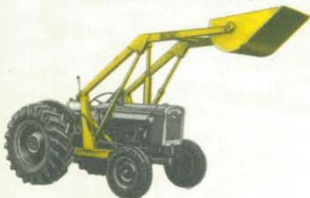
PÁ CARREGADEIRA agrícola. Acionada pela bomba do trator. Válvula direcional que permite o uso dos 3 pontos. Construção leve (de 430 a 485 kg). Fabricamos também modelos industriais.
