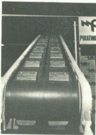
**TRANSPORTADOR MÓVEL** — De correia, pode empilhar 1 500 sacos por hora, à altura máxima de 5,4 m. As taliscas de peroba permitem um ângulo de inclinação de até 65°. A largura da correia é de 508 mm e sua velocidade de 35 m/min. O motor elétrico, totalmente fechado, tem potência de 2 HP a 1 140 revoluções por minuto. Possui seis rodízios para movimentação em armazéns e locais de embarque. Movimento de translação manual. /SC-17.
