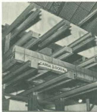
**PORTA-BARRAS** — Estruturas adequadas ao armazenamento de chapas de metal, barras, vergalhões, canos, tubos, vigas ou mesmo fardos de metal. Têm braços em balanço, ajustáveis, para facilitar a carga e descarga. Cada braço pode suportar peso de até 2 t. A colocação e retirada da carga pode ser efetuada com empilhadeira. /SC-23.
