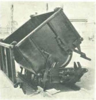
**VAGONETA BASCULANTE** — Corre sobre trilhos, para transporte de carvão, areia, pedregulho, minérios, etc., em pátios de carga de indústrias, minerações ou em grandes obras. Sua capacidade é de 2,5 m<sup>3</sup> e pode bascular para ambos os lados nas operações de descarga. São fabricados vários modelos de vagonetas, considerando tipo e volume de carga e locais de operação. /SC-22.
