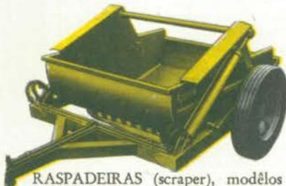
RASPADEIRAS (scraper), modelos agrícolas e rodoviários. Comando hidráulico por circuito independente. Permite carga, transporte e descarga pelo acionamento de um único comando. (sistema MADAL patenteado)
