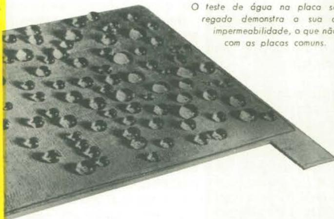
O teste de água na placa sêco-carregada demonstra a sua absoluta impermeabilidade, a que não ocorre com as placas comuns.
