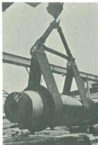
**LAÇOS** — O primeiro, de arame trançado para trabalhos pesados, tem largura de 508 mm e capacidade de carga de até 40 t. Adaptado ao gancho de uma ponte rolante ou pórtico, movimenta pistões e peças cilíndricas com diâmetro de 1 250 mm.
