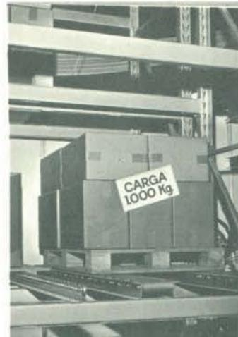
**ESTOCAGEM MECANIZADA** — Prateleiras providas de transportadores ligeiramente inclinados — estruturas roll in —, para colocação de mercadorias paletizadas, eliminam a necessidade de corredores nas áreas de estocagem. A inclinação permite que os pallets deslizem por gravidade. Os transportadores são fabricados com roletes, para suportar cargas de 1 t. Quando construídos com rodízios, a capacidade é de 300 kg. /SC-43.
