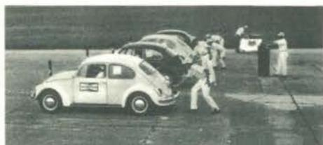
Como ocorre em tôdas as provas de aceleração, estes Volkswagens começaram a acelerar no momento em que um técnico pressionou uma chave de comando. Isto fez com que automaticamente, cada motor acelerasse até o máximo, ao mesmo tempo.
