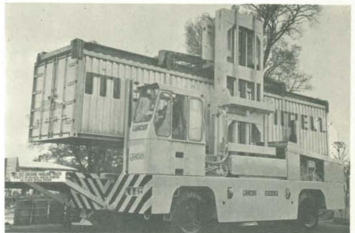
**EMPILHADEIRA LATERAL** — Pode carregar e descarregar pelos dois lados, permitindo sua utilização em corredores estreitos de armazéns e fábricas. Em pátios de carga pode movimentar contentores, pallets, ou qualquer outro tipo de carga unificada que possa ser manuseada com garfos. Construída com capacidades que variam entre 1 e 35 toneladas. Vantagens deste modelo de empilhadeira: sua facilidade de manobra e a visibilidade do operador. /SC-20.
