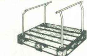
EC14 Para carga não acumulada com quatro entradas p/ empilhadeiras e carrinhos.
