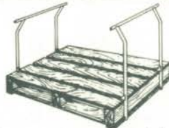
EE12 Para carga não acumulada com duas entradas p/ empilhadeiras e carrinhos.
