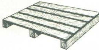
S12 Simples com duas entradas e uma face para empilhadeiras e carrinhos.
