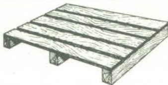
S12 Simples com duas entradas e uma face para empilhadeiras e carrinhos.
