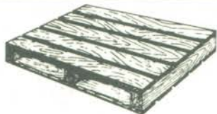
R22 Normal com duas entradas e duas faces para empilhadeiras.
