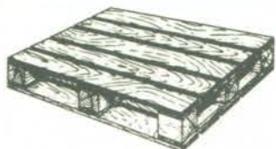
R24 Normal com quatro entradas e duas faces para empilhadeiras.
