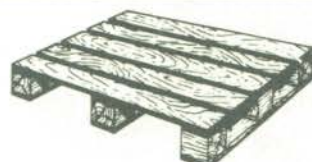
R14 Normal com quatro entradas e uma face para empilhadeiras e carrinhos.
