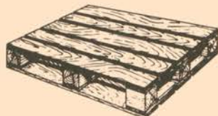
R24 Normal com quatro entradas e duas faces para empilhadeiras.
