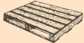
R12 Forte com duas entradas e uma face para empilhadeiras e carrinhos.
