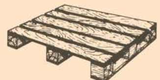
R14 Normal com quatro entradas e uma face para empilhadeiras e carrinhos.
