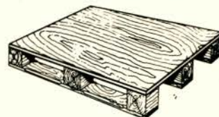
C14 Painel cheio c/ quatro entradas e uma face para empilhadeiras e carrinhos.
