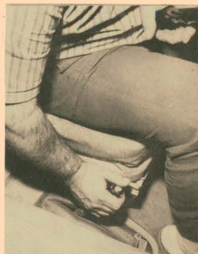
A posição do freio de mão requer do motorista posição algo incômoda cada vez que precisa acioná-lo.
