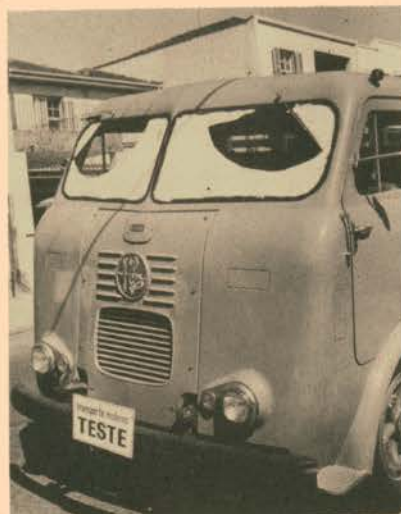
A área coberta pelo limpador do pára-brisa é pequena, dificultando a visibilidade nos dias de chuva.
