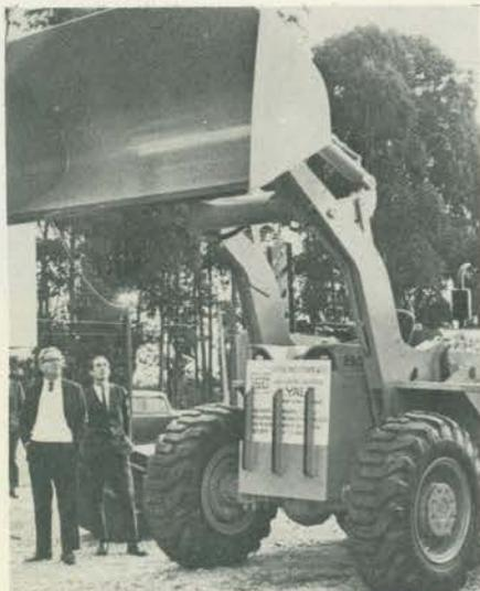
Entre os empreiteiros, a tendência, hoje, é utilizar equipamentos mais potentes e de capacidade cada vez maior. Para acompanhar essa tendência, a Eaton está lançando a pá carregadeira Trojan 250-A, caçamba de 1,91 m<sup>3</sup> (2,5 jardas cúbicas), motor Perkins de seis cilindros e 142 HP, carga máxima de tombamento de 9 200 kg, carga de operação de 3 500 kg.
