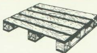
R14 Normal com quatro entradas e uma face para empilhadeiras e carrinhos.
