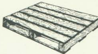
R12 Forte com duas entradas e uma face para empilhadeiras e carrinhos.
