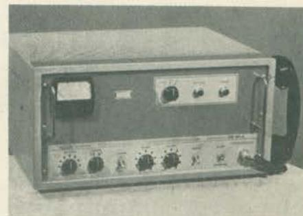
**RÁDIOTELEFONE** — Transceptor radio-telefônico para serviços intermitentes, em SSB. Dois modelos, para um e dois canais, estes simultâneos e independentes. A potência é de 100 watts. Alimentação com corrente alternada de 110 ou 220 volts. O modelo monocanal pode funcionar com bateria de 12 volts. /SC-3
