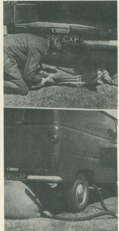
**MACACO DE BORRACHA** — Um balão de borracha reforçada, inflado pelos gases de combustão do próprio motor, substitui com vantagem os macacos hidráulicos. Vazio, é mais leve e ocupa pouco espaço. Pode ser aplicado em qualquer ponto do veículo graças ao seu formato. Uma válvula permite baixar o veículo lentamente. /SC-6
