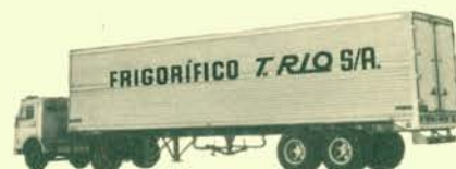
SEMI-REBOQUE FURGÃO ISOTÉRMICO FRIGORÍFICO - FABRICAÇÃO TRIVELLATO
