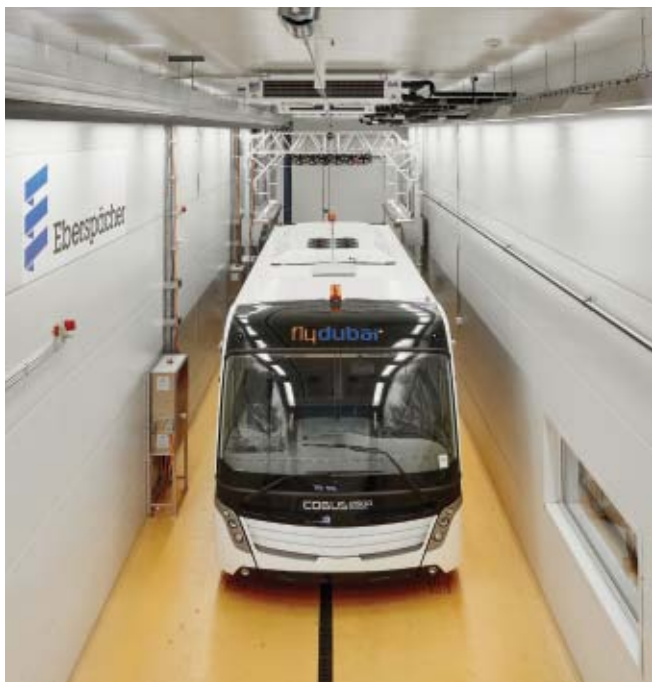
Câmara de calor (climática) disponível em Renningen, na Alemanha, para rigorosos testes em ônibus até 23 metros de comprimento, segue as rígidas normas internacionais de gerenciamento de temperatura
