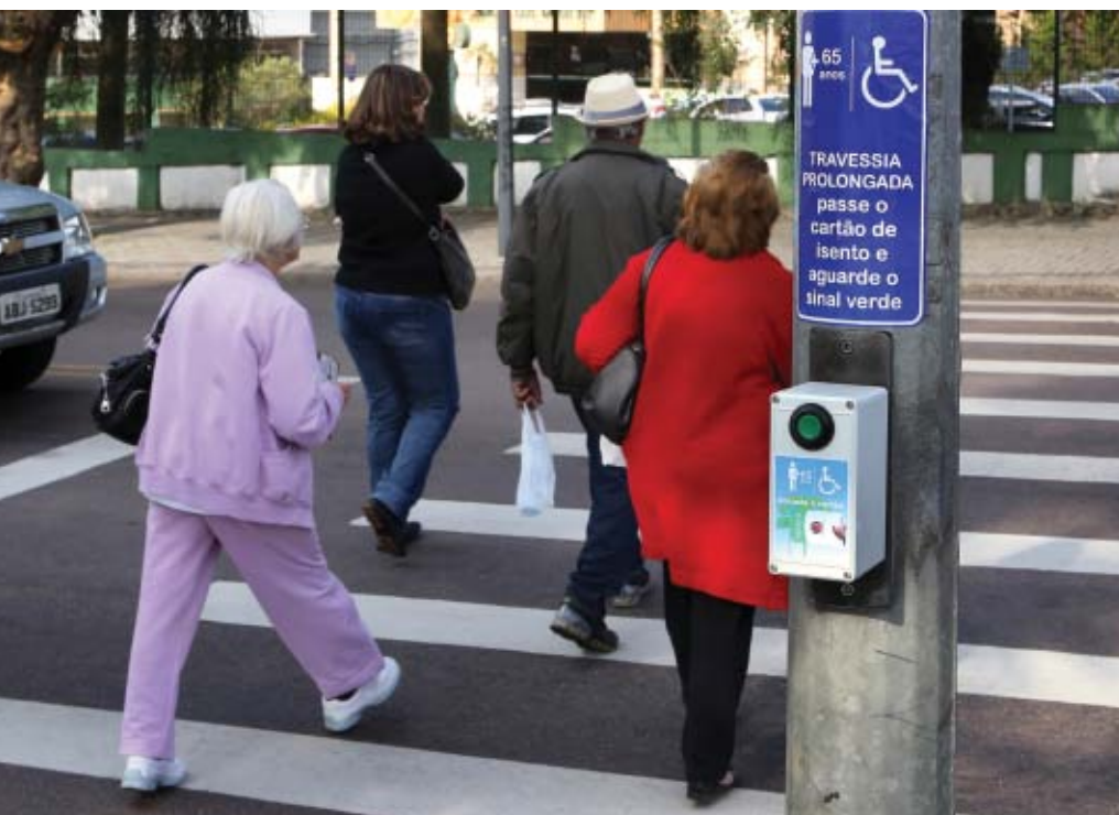
Botoeira inteligente da Dataprom, que utiliza o cartão-transporte do usuário para proporcionar mais tempo de travessia no semáforo
