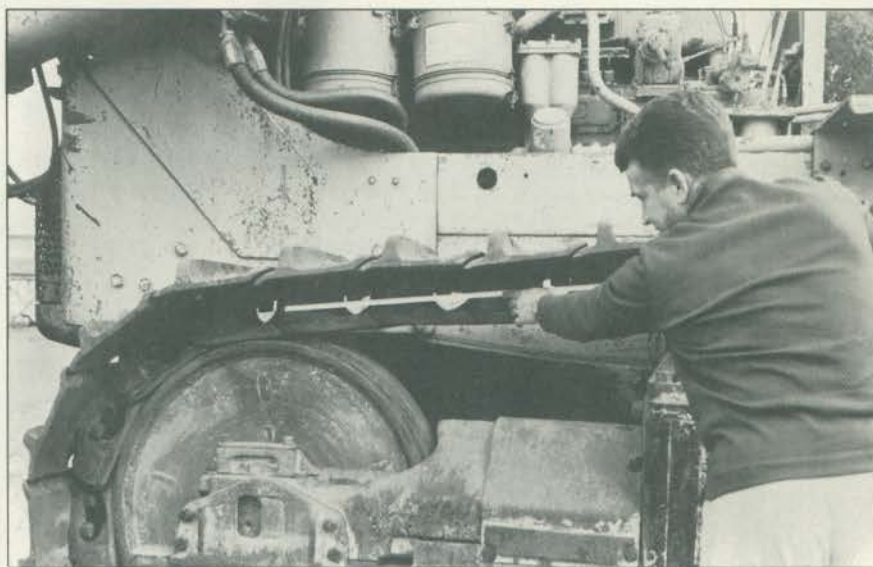
Desgaste de pinos e buchas é avaliado, para giro, na medição da esteira.
