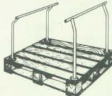
EC14 Para carga não acumulada com quatro entradas p/ empilhadeiras e carrinhos.
