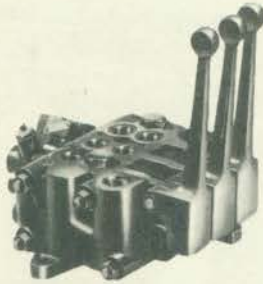
(Comando Direcional Múltiplo. Mod. Cm.11. Conjuntos de até 10 comandos, para pressões até 170 atmosferas.)
