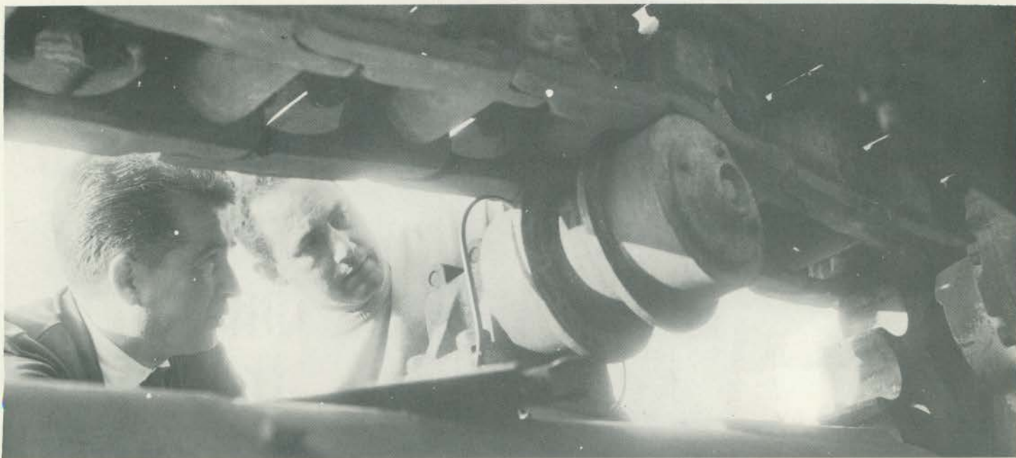
Técnico de fábrica nacional mede desgaste de componentes para determinar o "item crítico" a observar na manutenção.
