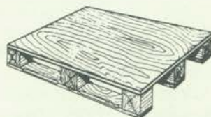
C14 Paineis cheios com quatro entradas e uma face para empilhadeiras e carrinhos.
