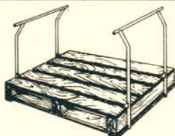
EE12 Para carga não acumulada com duas entradas p/ empilhadeiras e carrinhos.
