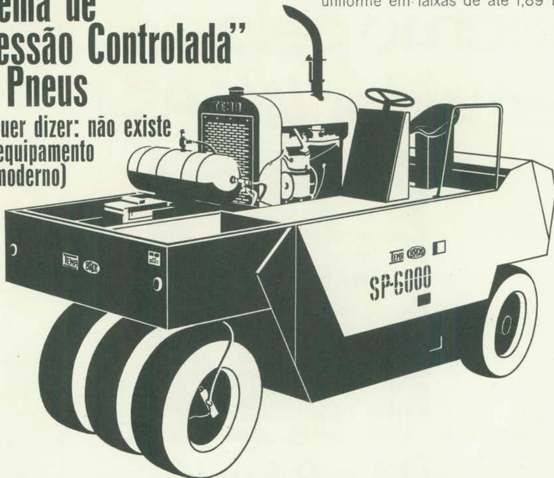
Eficiente. Versátil. Robusto. Mecanicamente perfeito. Tudo isso resume o novo lançamento da Tema Terra: Rôlo Autopropulsor de Pneus SP-6000, o mais avançado equipamento do gênero fabricado na atualidade. Graças a uma largura maior de rolagem e à perfeita distribuição de suas 21 toneladas (6.000 libras por roda), assegura compactação uniforme em faixas de até 1,89 m.
