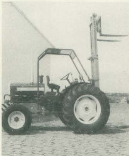
O trator-empilhadeira tem capacidade para 2.000kg e elevação de 3.520 mm.
