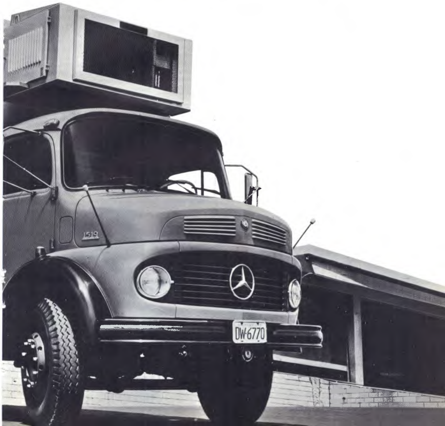
O LS-1519 é um cavalo mecânico de 32 toneladas para semi-reboque de dois eixos, que pode ser adquirido com cabina simples (3600mm entre eixos) ou com cabina dupla de dois leitos (4200mm entre eixos).
