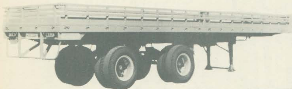
SEMI-REBOQUE PARA CARGA SÉCA MASSARI M-28. DOTADO DE SUSPENSÃO AUTODIRECIONAL.
