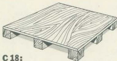
C 18: Painel cheio de 8 entradas e uma face para empilhadeiras 90 x 120 e 120 x 120
