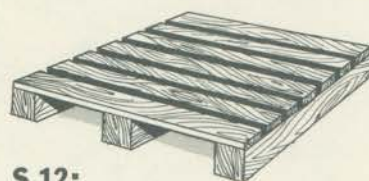
S 12: simples de 2 entradas e uma face para empilhadeiras 90 x 120 - 120 x 120 e 120 x 150
