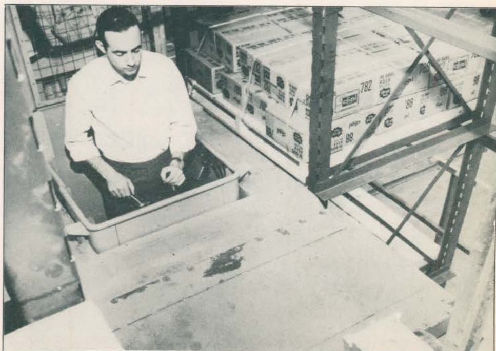
O operador acompanha a plataforma, subindo até o ponto de carga e descarga.
