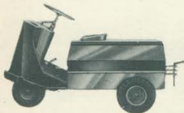
TRATOR ELÉTRICO E A GASOLINA Capacidade de tração até 10.000 Kg
