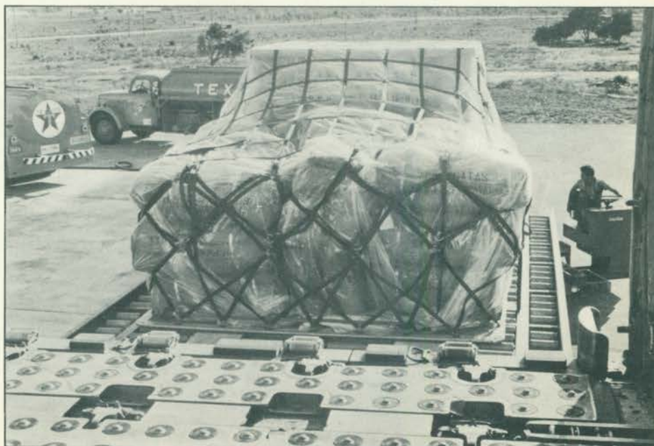
A carga é preparada sobre estrados-padrão antes do pouso da aeronave.
