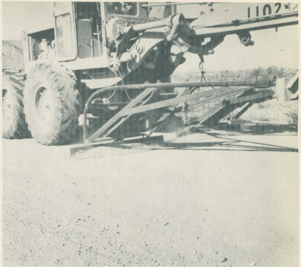
Barras de tração duplas podem testar dois tipos de aço, em uma mesma prova.
