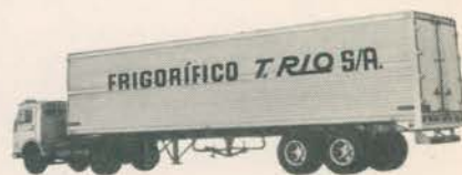
SEMI-REBOQUE FURGÃO ISOTÉRMICO FRIGORÍFICO - FABRICAÇÃO TRIVELLATO
