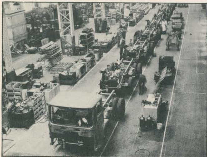
SEM EMBREAGEM — Numa linha especial de produção da Leyland Motors — Inglaterra — foram fabricados os primeiros 100 caminhões Beaver, sem embreagem. Destinados a operar com semi-reboques, com capacidade bruta de 30/32t, seus controles consistem apenas no acelerador e pedal de freio, com pequeno seletor de engrenagem.
