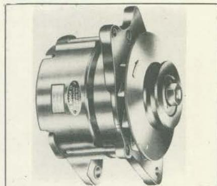
**ALTERNADOR** — Lançado novo tipo de alternador, que substitui o dínamo convencional. Com capacidade de 35 ampères, trabalha com mil a 12 mil rpm e permite carregar a bateria mesmo com o motor em marcha lenta. Funciona em sistemas elétricos de 12 volts. Indique Serviço de Consulta n.º 4.
