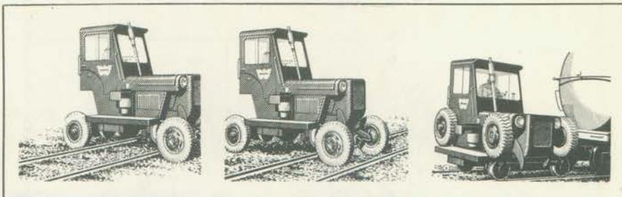
**VAGÕES E CARRÊTAS** — Manobras de vagões nas ferrovias e tração de carrêtas em pátios de carga são efetuadas por este novo veículo de características especiais. Dispõe de truques para rodar sobre trilhos e de pneumáticos, para movimentar-se sobre asfalto ou chão batido. Manobra vários vagões ao mesmo tempo. S.C. n.º 1.
