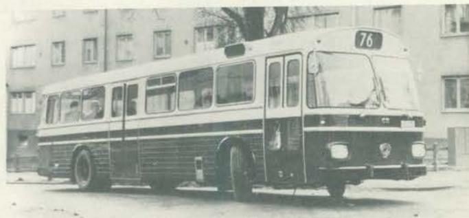
**NÓVO MODELO** — A Scania-Vabis sueca está submetendo a testes um novo modelo de ônibus. Tem suspensão pneumática, caixa de câmbio totalmente automática e laterais de chapa de aço especial, para proteção contra colisões. Pesa 7.800 quilos e transporta 80 passageiros.
